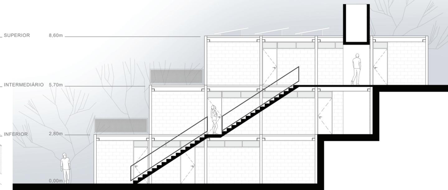
CORTE | IMPLANTAÇÃO ESCALONADA | ESC. 1:125
